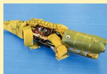
卒業作品として、リモコン操作により歩行するだけでなく、口は開閉し、尾が回転するワニロボットを製作しました。オープンキャンパスでは、このロボットを使ったゲームも体験できます。
